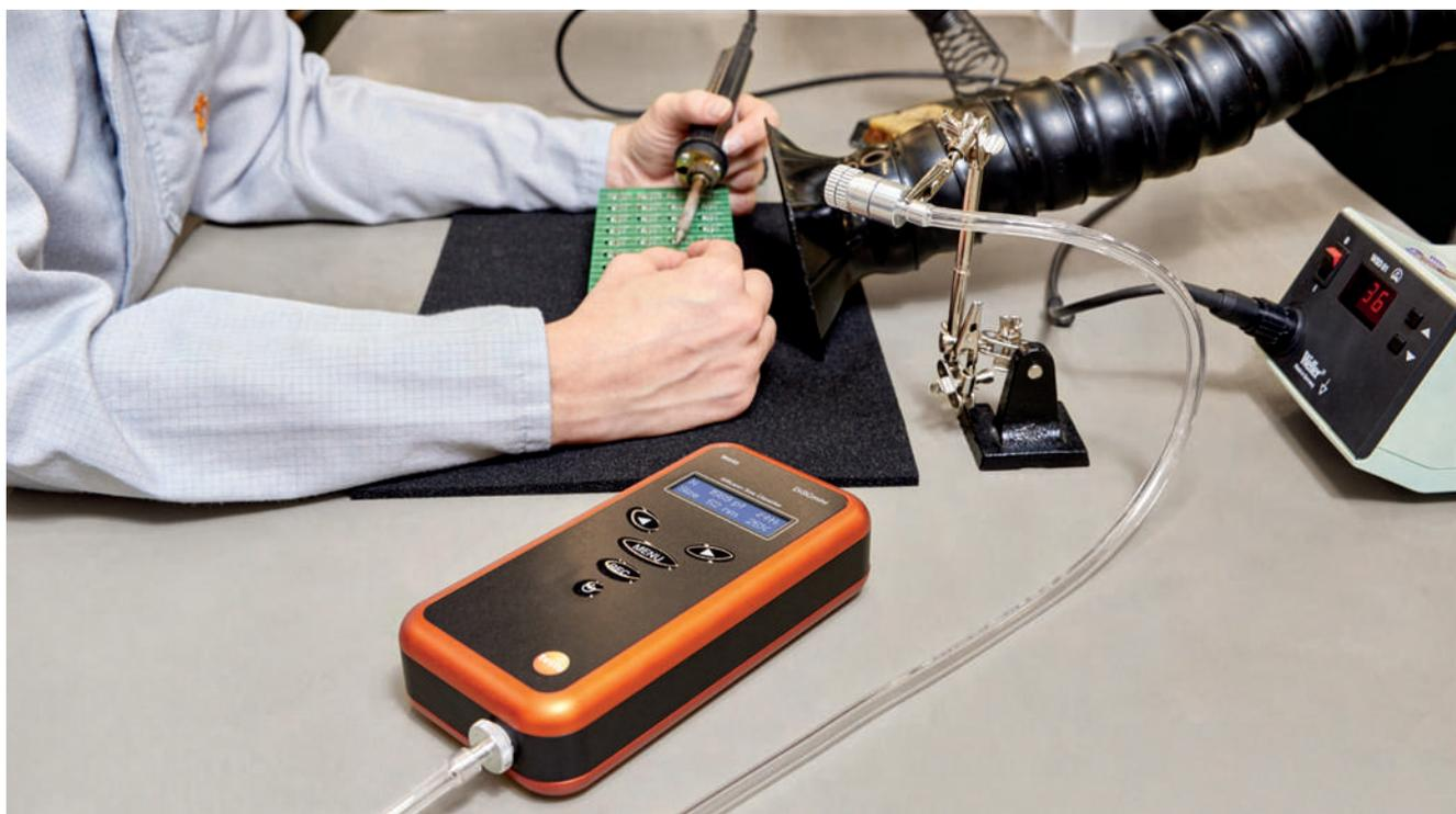
Fig. 2: Configurazione dell'ambiente di lavoro da misurare con stazione saldante e aspiratore.
